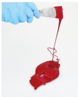
Hilo largo de la tinta. | Hilo corto tras añadir carbonato de magnesio.
